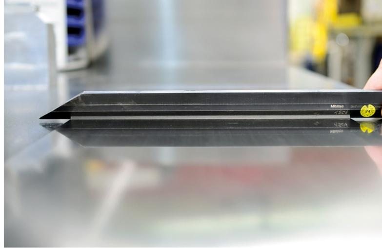
Darüber hinaus trägt die erhöhte Planheit maßgeblich zur Langlebigkeit der Produkte bei, da die Formstabilität im Einsatz durch das reduzierte Kaltrichten positiv beeinflusst wird.
